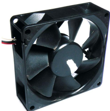
Ventilador al cual se le ha hecho una marca con tippex para medir su velocidad
