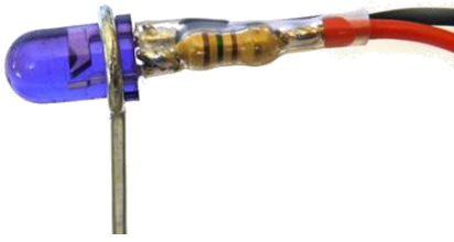
Fotodiodo TSUS540 en un soporte de alambre
